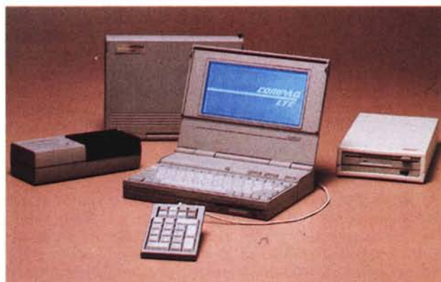
Visione «esplosa» del nuovo portatile Compaq: si noti il piccolo modem opzionale inseribile a destra e la batteria NiCd a sinistra. Tutta l'elettronica della macchina è disposta tra l'hard disk e la meccanica per microfloppy da 1.44 mega.
