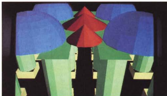
Figura 12 Autocad - Autoshade. In questo applicativo il colore assunto da ciascuna superficie, o areola se si tratta di superfici curve, degli oggetti rappresentati, dipende sia dal suo colore originale, sia dalla modalità con la quale è stato illuminato. In tal senso il colore risultante deriva dall'applicazione di un algoritmo trigonometrico complesso.
