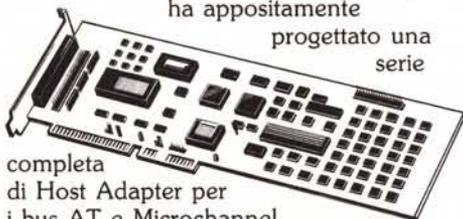
completa di Host Adapter per i bus AT e Microchannel, nati per supportare HDD e FDD con protocollo SCSI in ambiente multiuser.
