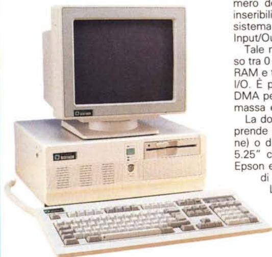
**S**econdo una tendenza che si sta rapidamente diffondendo anche la Disitaco offre un modello che, come il nome Starter indica chiaramente, rappresenta l'entry point della gamma di sistemi MS-DOS basandosi per l'occasione sull'uso del processore NEC V20 operante in questo caso ad una frequenza di clock massima di 15 MHz.
