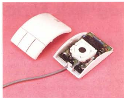
Nel Logitech PS/2 la sfera è stata avanzata in posizione più centrale.
