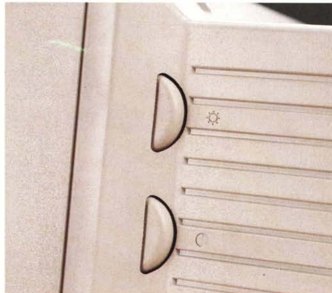
Le manopole di regolazione contrasto-luminosità, integrate nel corpo del video.
