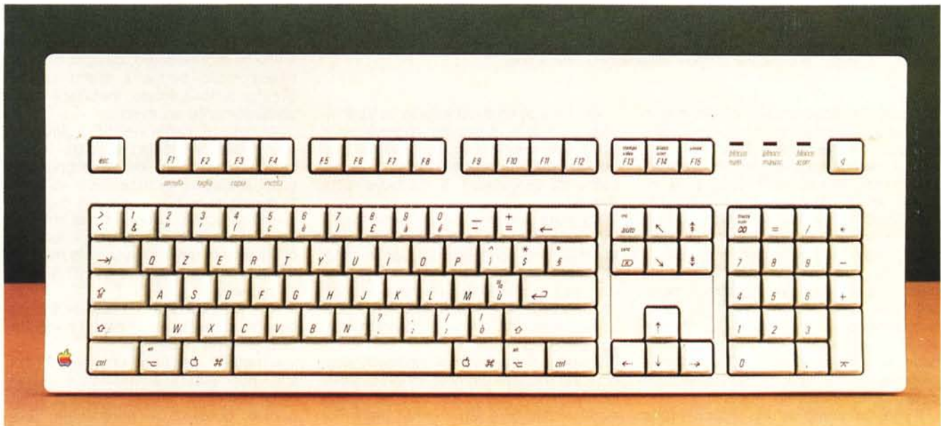
La tastiera estesa, con i tasti funzione, di cui alcuni già predefiniti per le funzioni più diffuse; sebbene più completa, non è sempre preferibile a quella normale, più pratica e maneggevole.
