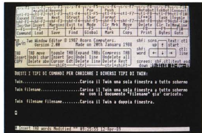
Figura 2 - Quello che vedete in figura (e che viene in parte commentato nell'articolo) è il piccolo programma-esempio presente sul manuale. Quelle nove righe di testo stanno per essere assembleate nella seconda finestra aperta in screen attraverso la chiamata del TASK STATUS, tramite l'ARM BBC BASIC.
