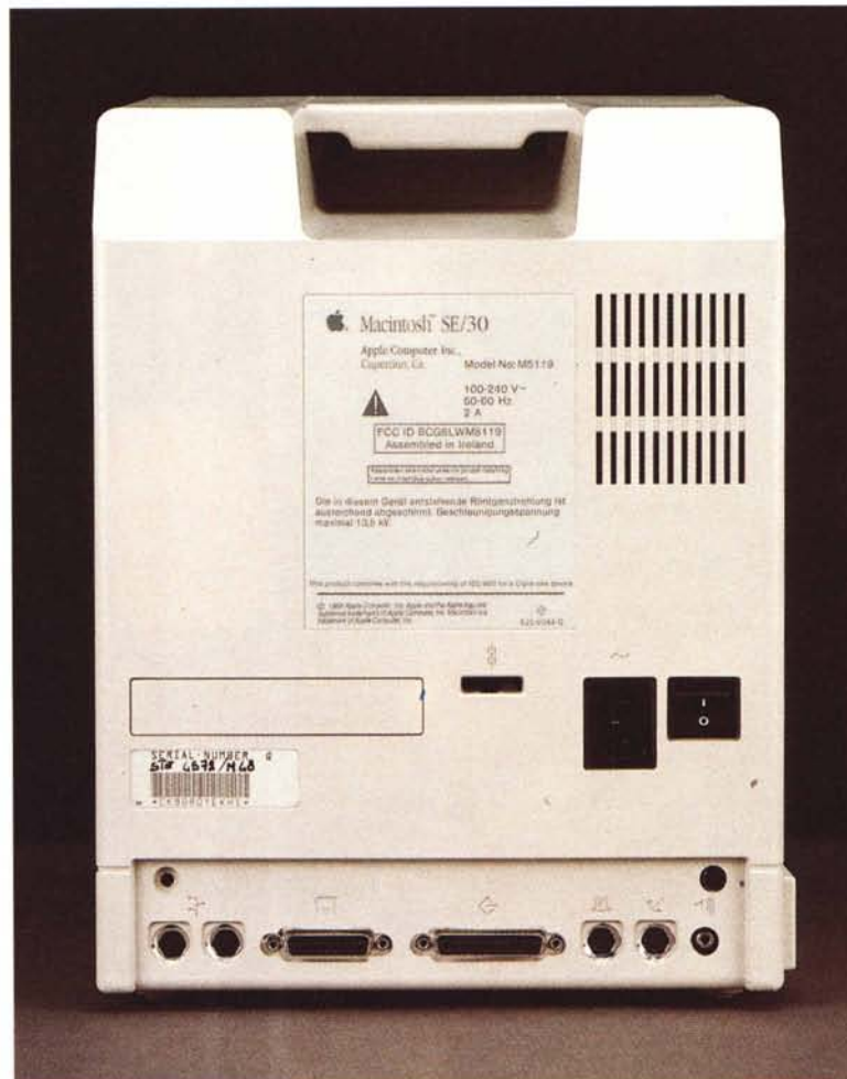
Il retro della macchina, con, nell'ordine, da sinistra, le due prese dell'Apple desktop, la porta RS 232 per il collegamento del driver esterno, la presa SCSI, e le due porte modem-stampante. In fondo si vede la presa minijack, stereo e, più in alto, a sinistra dei connettori di alimentazione, la presa per l'accesso al connettore interno.
