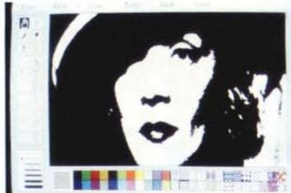
Figura 10 - Immagine scannerizzata in modalità Line-Art.
