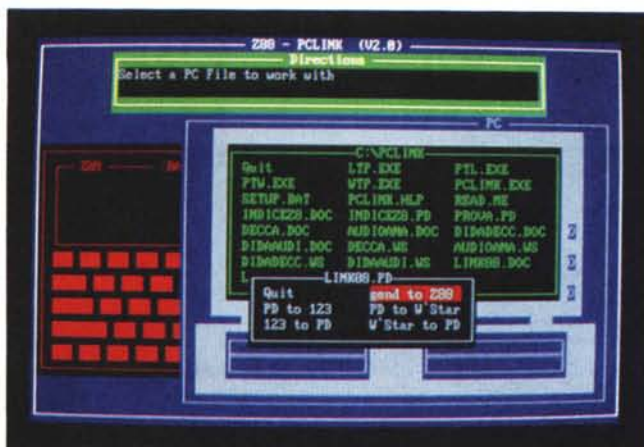
Ambiente PC-Link: sono visibili i menu corrispondenti alla scelta del file su PC ed al tipo di operazione da eseguire.
