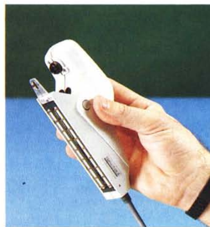
Figura 3 - Lo scanner TransImage 1000 - Vista di sotto. Si nota l'obiettivo della telecamera che punta il mirino sotto il quale va fatto scorrere il testo. Il mirino è illuminato da due luci rosse che possono essere regolate via software in funzione delle condizioni di contrasto del foglio da leggere, per mezzo di un apposito menu. Si notano poi i due rulli paralleli che vanno fatti ruotare durante la lettura.
