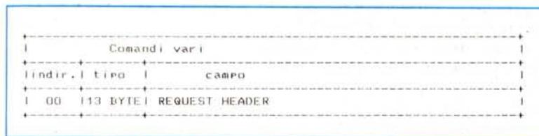
Figura 3 - Struttura del Request Header nel caso di chiamata alle routine INPUT STATUS, OUTPUT STATUS, INPUT FLUSH, OUTPUT FLUSH, OPEN, CLOSE e REMOVABLE MEDIA: in tutti questi casi, infatti, la funzione non ha bisogno di campi aggiuntivi, ma deve solo settare alcuni campi all'interno del Request Header stesso, come è spiegato in dettaglio nell'articolo.
