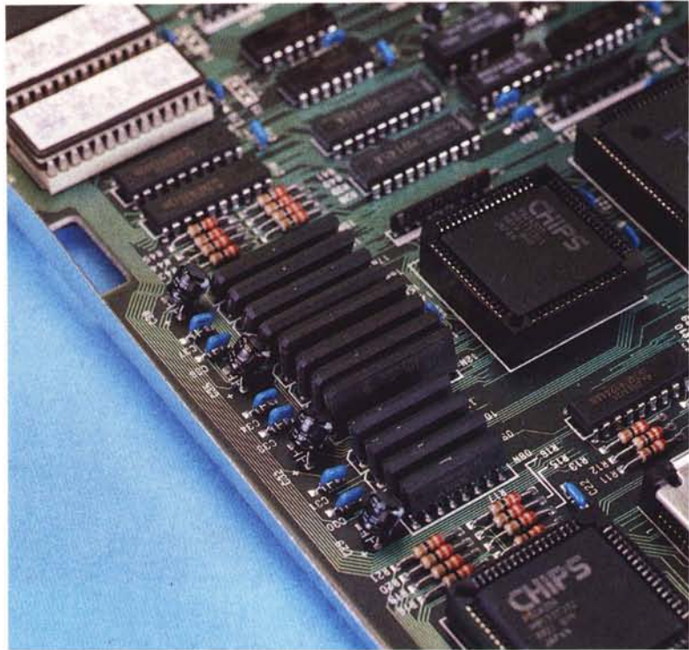
In basso la scheda madre ricca di componenti, ma dalla «pulizia» esemplare. In alto, il banco ram... disposto verticalmente.
