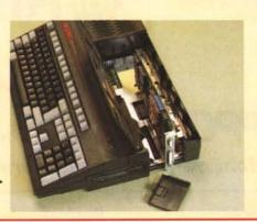
Il PC200 dispone di un connettore per l'inserimento di un disk drive esterno da 3.5 o 5.25 pollici e logicamente per il collegamento di monitor monocromatici ed a colori.
