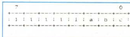
Figura 3 - Ecco il cosiddetto «media descriptor byte» i cui tre bit che possono variare (almeno fino alla versione 3.1 dell'MS-DOS) sono stati indicati con «a», «b» e «c»: rimandiamo al testo per le varie combinazioni possibili.
