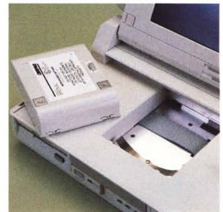
Il vano portabatterie si trova sotto la tastiera.
