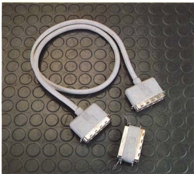
Le due immagini illustrano i due tipi di cavo necessari per collegare l'AppleCD SC al nostro sistema Macintosh: la foto a sinistra mostra quello necessario per il collegamento ad un'altra periferica SCSI già presente, mentre quello a sinistra serve per collegarlo al computer. Il piccolo connettore è il terminatore.
