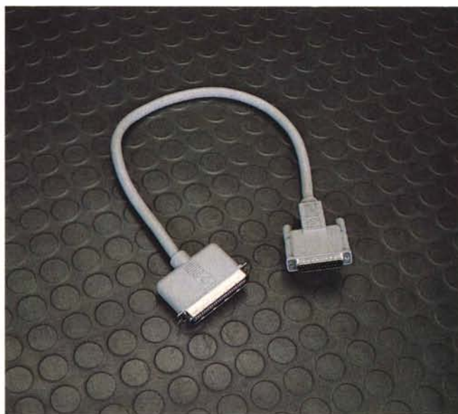
Le due immagini illustrano i due tipi di cavo necessari per collegare l'AppleCD SC al nostro sistema Macintosh: la foto a sinistra mostra quello necessario per il collegamento ad un'altra periferica SCSI già presente, mentre quello a sinistra serve per collegarlo al computer. Il piccolo connettore è il terminatore.
