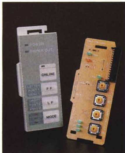
Il pannellino operativo, nonostante la sua relativa semplicità, sovrintende a numerose operazioni di controllo. Il connettore dell'interfaccia è posizionato in maniera tale da non intralciare il percorso della carta.
