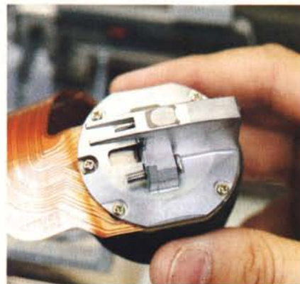
Un particolare della testa di stampa a 24 aghi.
