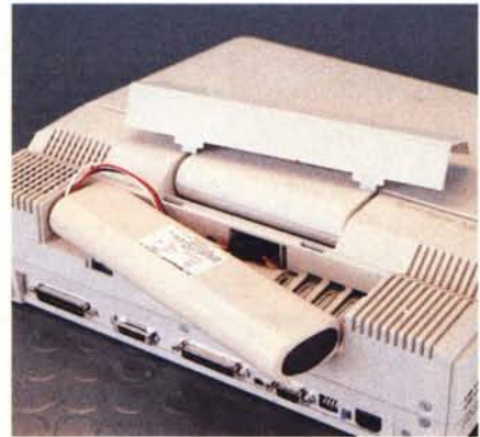
Il vano portabatterie accessibile dall'esterno.
