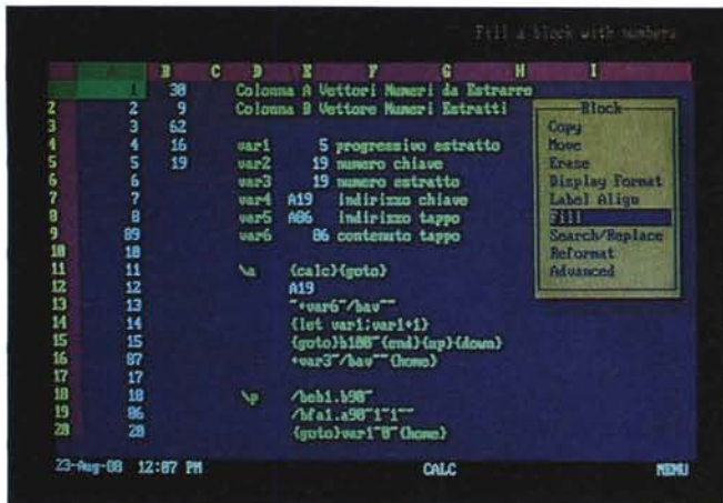
Figura 7 Tombola. Riempimento del tabellone. Nel secondo esercizio si cominciano ad utilizzare le Macro. In questo caso il tabellone è inizialmente vuoto sia di numeri che di formule. È la Macro A, richiamabile cioè premendo alt+A, che estrae il numero e lo posiziona, facendocelo rimanere, nel tabellone. La Macro \P invece pulisce il tabellone.
