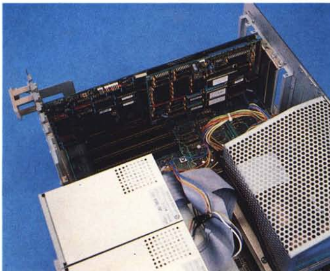
La scheda bridge board va installata in uno dei due slot tripli ossia contenenti tutt'e tre i bus: Amiga, PC, AT.
