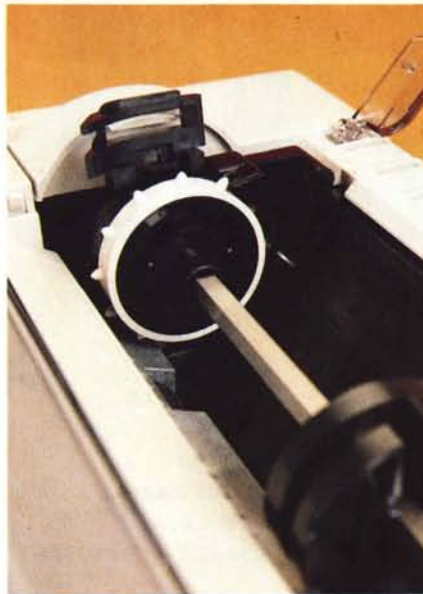
NEC P2200: il particolare dei trattori di «spinta/tiro» che rendono possibile l'uso combinato di varie soluzioni di alimentazione della carta.
