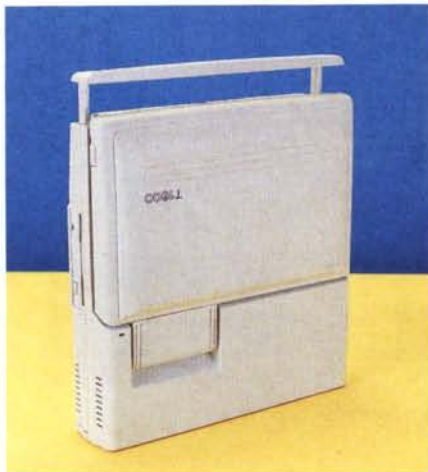
A destra il retro della meccanica con lo sportello-supporto chiuso e aperto. In alto la nuova maniglia estraibile.
