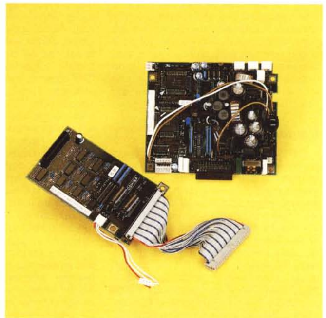
La scheda alimentatore-carica batterie e il controller dell'Hard Disk standard ESDI.
