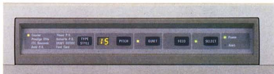
In alto il completo pannello dotato di display che presiede al controllo di tutte le funzioni della stampante ed alla scelta dei font e del pitch dei caratteri. A fianco si può vedere come si accede ai trattori di spinta integrati nel meccanismo di stampa.
