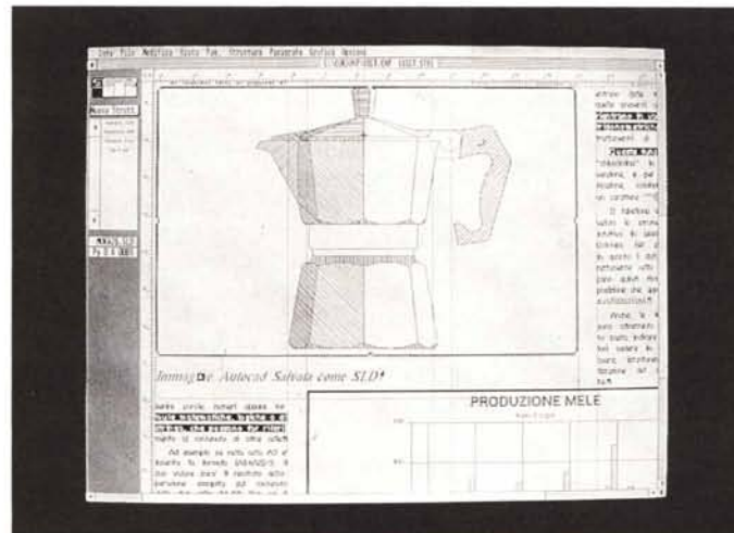
Figura 7 Autosketch in Ventura. Autosketch può essere utilizzato anche quando il problema è quello di realizzare dei disegni, non di tipo rigidamente tecnico, finalizzati al loro uso in Ventura. Si salvano in formato DXF e si convertono con la citata utility DXFTOGEN. Il lavoro va ottimizzato soprattutto per quanto riguarda il dimensionamento del disegno, che può essere eseguito nell'ambiente iniziale o in quello finale.
