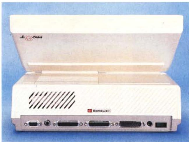
Sul retro troviamo le interfacce seriale e parallela, una porta per drive esterno, più le connessioni per il monitor esterno.
