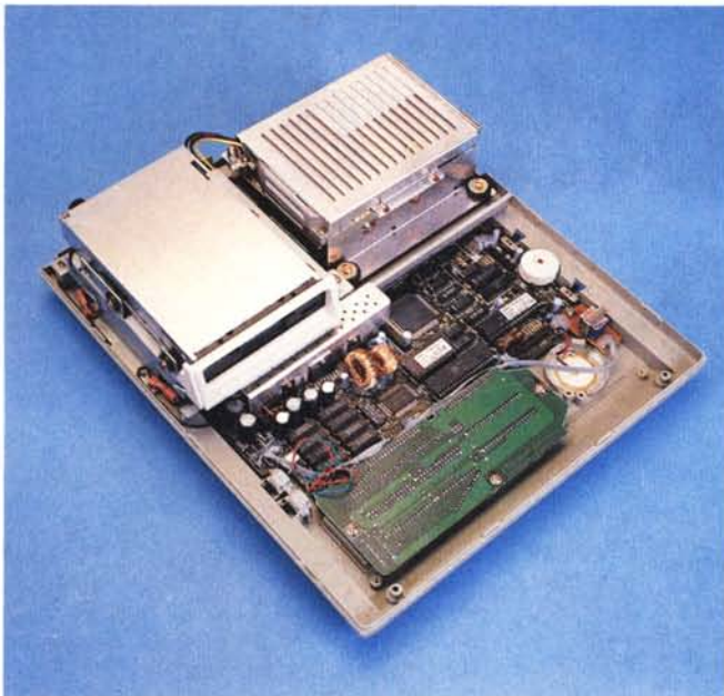
Una veduta della macchina appena aperta e, qui a destra, la piastra contenente tutta l'elettronica di base, il controller per i floppy disk, il modem e l'alimentatore.
