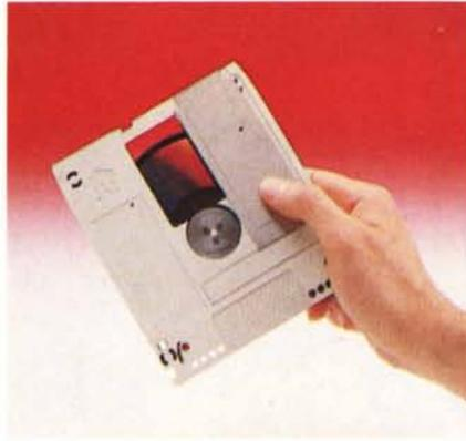
Ecco le due cartucce ottiche: la Maxtor usa una resina sintetica per ricoprire il film che viene inciso, ottenendo una cartuccia più sottile della Optotech.
