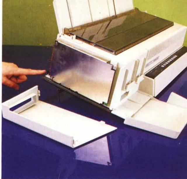
La modularità del cabinet permette il facile accesso alla scheda di interfaccia fissata con un originale sistema a pressione indicato nella foto. Il pannello di controllo permette numerose selezioni visualizzate nel comodo display.
