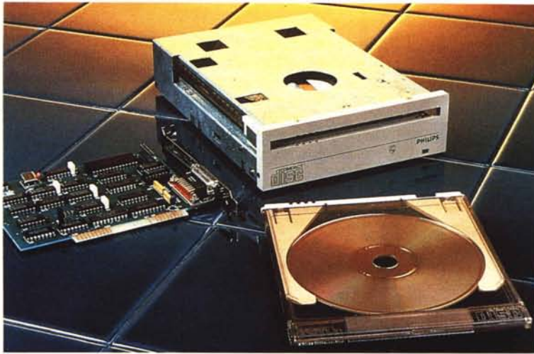
Occupa solo mezza altezza il nuovo drive Philips CM 201, costruito dalla L.M.S. olandese.
