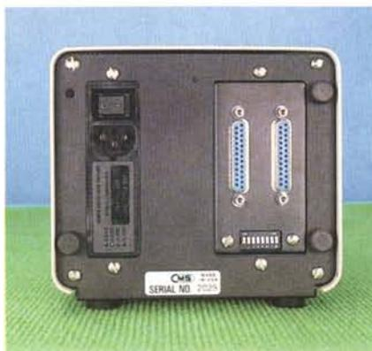
Sul retro del CMS si possono notare i connettori di collegamento, il cambiensione ed alcuni switch di settaggio.
