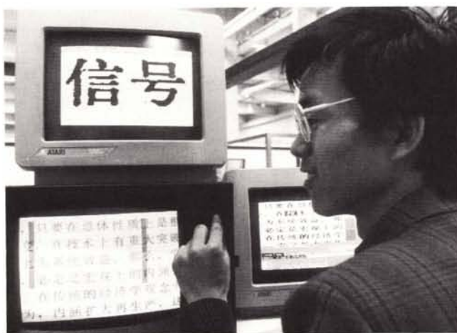
Questo è un sistema di riconoscimento a telecamera di ideogrammi cinesi.
