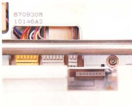
A sinistra la compatta testa di stampa a 9 aghi facilmente asportabile; qui sopra il connettore presente sulle MSP 5x per l'installazione del kit di stampa a colori e, per finire, una prova di stampa in grafica (purtroppo in B/N).
