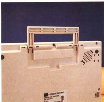
Il T1200 dispone, come gli altri Toshiba, di una comoda maniglia per il trasporto.
