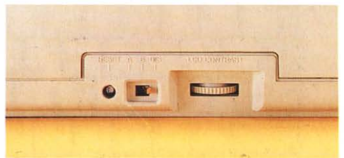
Particolare del fianco sinistro: regolazione del contrasto e selettore per il drive esterno.
