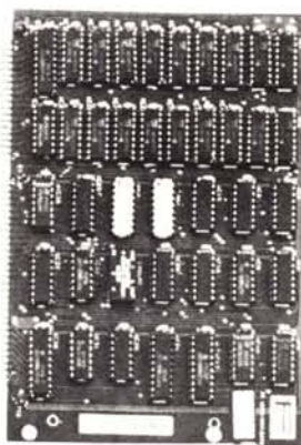
AT-128K RAM CARD — Provvede ad espandere la memoria RAM da 512K a 640K Cod. 12.0895
