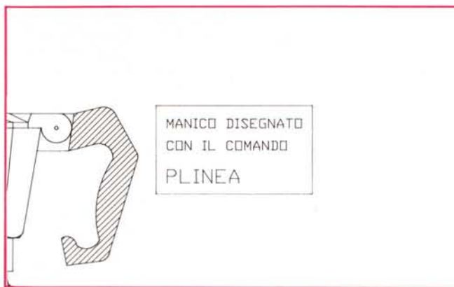
Figura 7 - PARTICOLARE DEL MANICO - POLILINEA Il manico è realizzato mediante segmenti ed archi di vario raggio. Non forniamo le coordinate dei vari elementi in quanto è più facile per chi segue il corso agire in autonomia.
