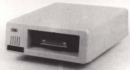
TS 60 Back up * Capacità formattato: 60 Mbytes * Tracce: 24 * Cartuccia: DC 2000 * Files: HFS/ProDOS * MTBF 20.000 ore.
