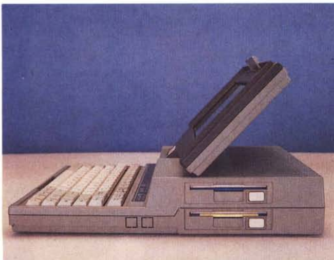
Il fianco destro e le fessure dei due drive.
