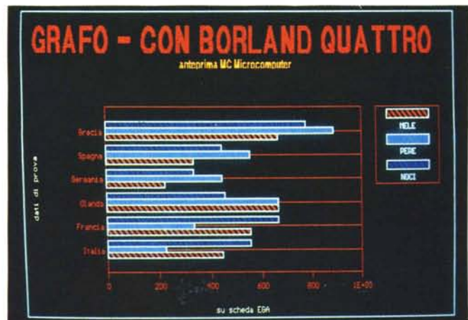
Figura 4 - Borland Quattro - Funzioni grafiche. Rispetto al modello 123, il Quattro presenta importanti innovazioni nella parte «grafica», non solo come tipologia di disegni producibili, ma anche in termini di impostazione di parametri. Nella foto ad esempio si noti la possibilità di settare tipi di caratteri, tipologia e colore dei riempimenti.
