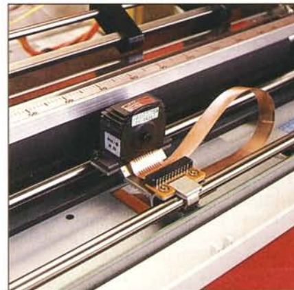
Due particolari della meccanica: il blocco dei motori di trascinamento e la testina di stampa.
