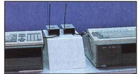
Sempre della OKI questi Modem con radio-trasmittitore incorporato per collegamenti senza fili tra computer e stampante a breve distanza (da considerare comunque che un cavo seriale a due fili può raggiungere comodamente i 50 metri), utili per collegamenti mobili.
