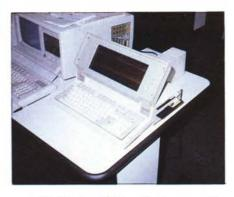
tura dei dati, inseribili mediante una tastiera IBM compatibile ad 88 tasti, avviene con un display LCD a tecnologia Supertwist capace di 25 linee di 80 caratteri.
