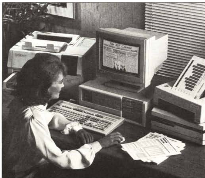
La soluzione AST Premium Publisher prevede, come hardware, un computer AST Premium/286 (IBM AT compatibile), uno scanner AST TurboScan da 300 punti per pollice e una stampante laser AST TurboLaser.
