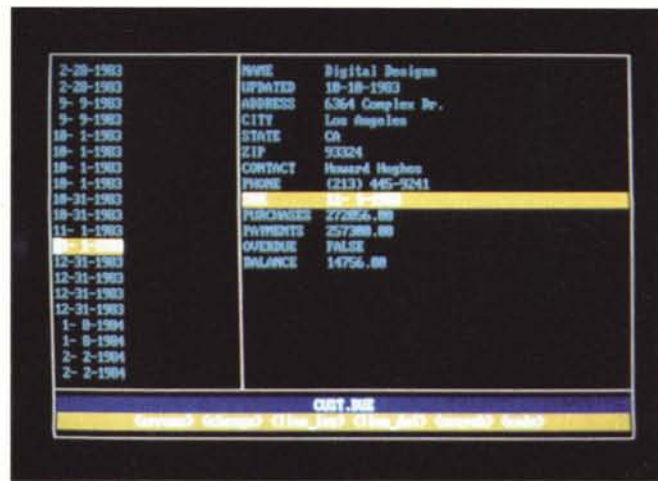
Figura 4 - Formato di stampa. Modalità di lavoro che permette di costruire Report in modalità Full Screen. Si possono indicare Label (scritte fisse nel tabulato, oppure intestazioni, ecc.), variabili di sistema (date, contatore delle pagine, ecc.) e i campi, espressi sia in forma diretta che manipolati.
