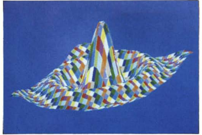
Figura 6 - Curva Tridimensionale - Metodo Linee - Output. Ogni elemento quadrangolare (nello spazio) è visualizzato per mezzo del suo perimetro. L'effetto è di un solido rappresentato tramite il suo scheletro. Un solido geometrico viene rappresentato per mezzo dei suoi spigoli.
