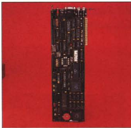
La scheda AST 3G I/O - Scheda lunga, basata sulla serie di chip della Chips & Technologies (i più diffusi). Dispone di numerosi accessori che ne fanno una multifunzione. Uscita stampante, seriale e Clock. Vengono forniti un dischetto di utility e un diagnostico.
