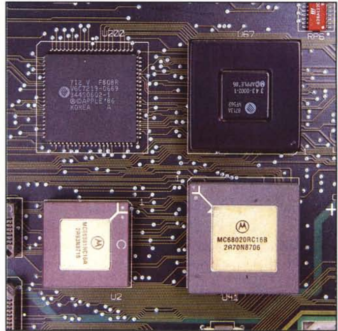
L'interno della macchina. A destra i 4 chip più importanti! processore, coprocessore matematico, MMU e il chip custom di produzione Apple.
