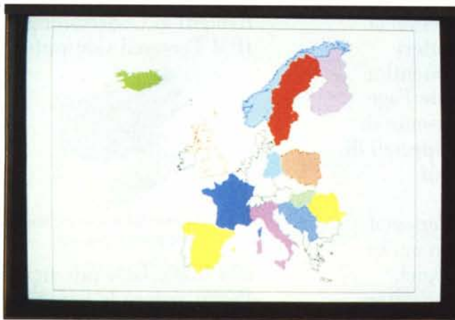
Figura 1 - Metodo di lavoro VECTOR. Ogni elemento è individuato come insieme di caratteristiche e di coordinate, per cui, in sede di visualizzazione, l'elemento può essere pesantemente manipolato, con qualsiasi tipo di operazione sugli elementi numerici. L'esempio mostrato è stato realizzato con il Freelance Plus della Lotus Corporation.
