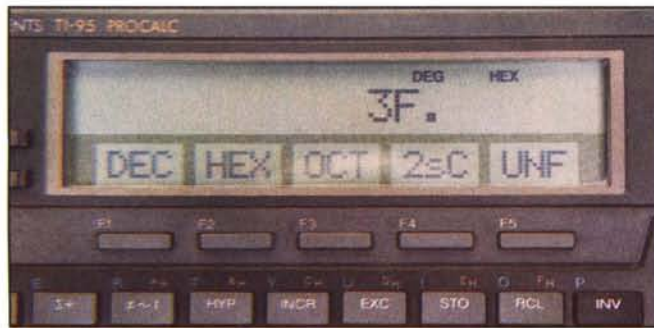
Due menu della TI-95: a sinistra le conversioni di base, a destra le operazioni di I/O.
