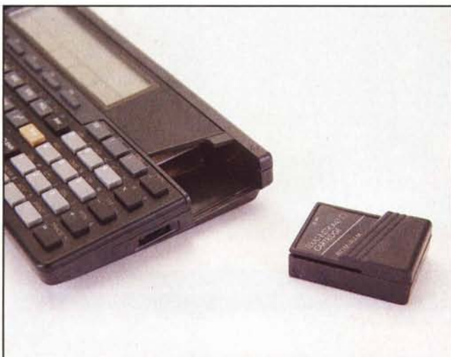
Nella TI-95 è possibile inserire moduli aggiuntivi. Qui sopra i moduli rom di matematica e statistica.
