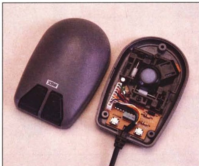
Il magnifico mouse con la «faccia da topo». L'azionamento dei due interruttori sulla basetta avviene mediante due «prolunghe» dei tasti.
