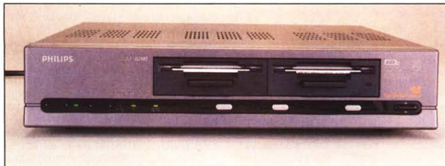
Il frontale del computer mette in evidenza la notevole dotazione per il controllo degli effetti audio e video con il superimpose.
