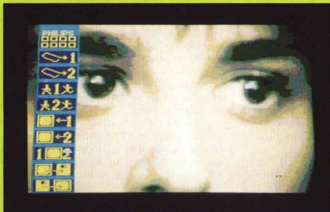
Sottomenu animazione su digitalizzazione singola. Spostamento di una porzione dell'immagine e relativo menu.
