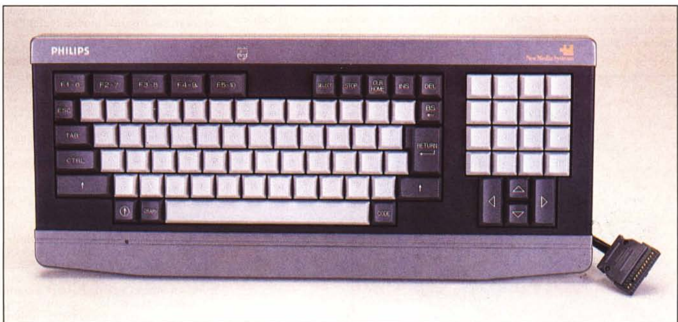
La bella tastiera dotata di pad numerico, si noti la disposizione dei tasti cursore e il connettore di collegamento.
