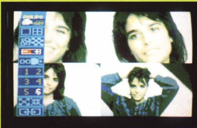
Digitalizzazione da telecamera a 4 frame con relativo menu. Digitalizzazione con disposizione casuale dei frame.
