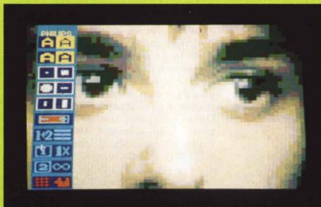
Sottomenu inserimento testi sull'immagine elaborata. Effetto reticolo sull'immagine con l'ingrandimento dei pixel.
