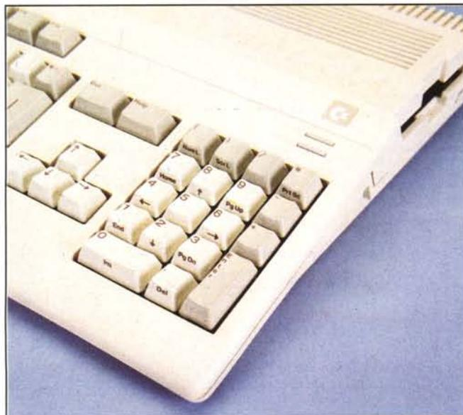
Il tastierino numerico dispone delle funzioni tipiche delle macchine MS-DOS. Forse un sidecar pure per il 500?
